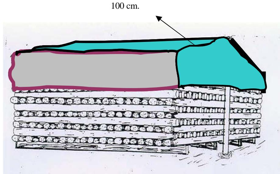
Apilado de postes bajo sombra (para postes de 13, 12 y 11 metros el apilado deberá tener hasta 8 camas y cuatro filas de durmientes de madera aserrada tratada)
